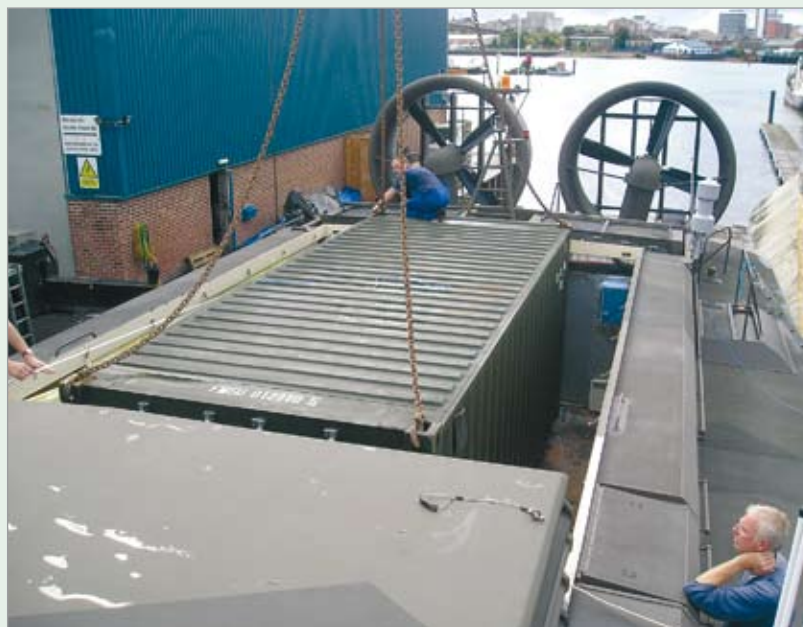
Den nya svävaren är en mycket flexibel plattform och kan användas för olika lastfall. Här lyfts en 20 fot standardcontainer i. Foto: Försvarmakten
